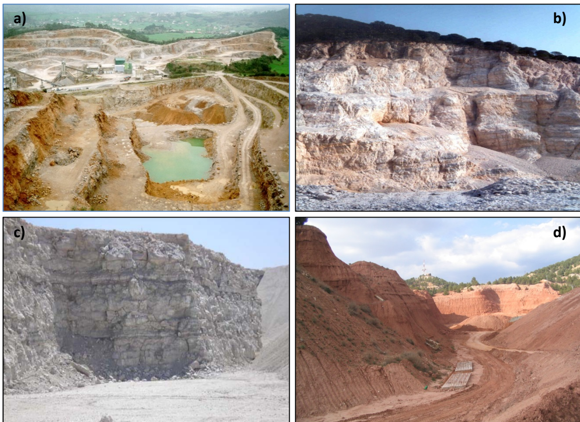
Figura 5. Canteras de rocas industriales de: a) y b) calizas para áridos de machaqueo en Camargo (Cantabria) y Alhaurín de la Torre (Málaga); c) yesos en Pina de Ebro (Zaragoza) (Rubio Navas et al. , 2007); y d) arcillas en Teruel
