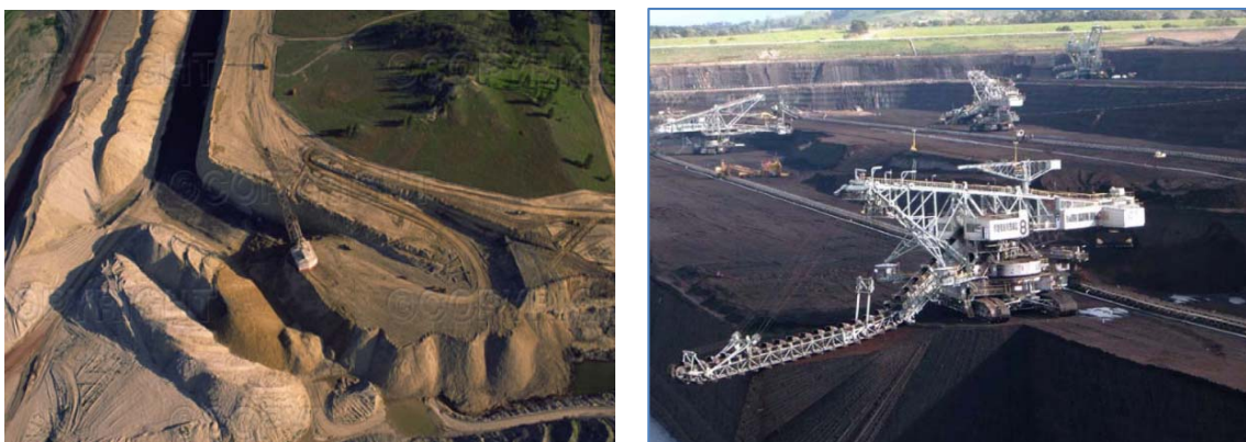
Figura 3. Izquierda: explotación de carbón por el método de descubierta (Romero, 2006). Derecha: explotación de carbón por el método de terrazas (Herrera Herbert, 2006)
